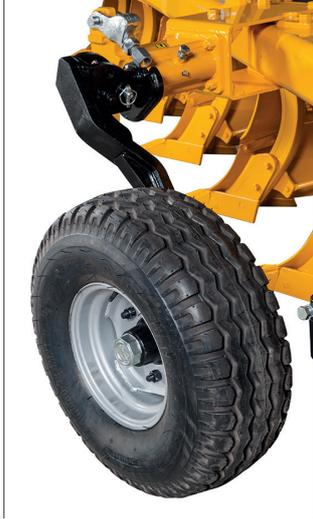
Roue hydraulique pour l'emplacement du chemin (en option)
